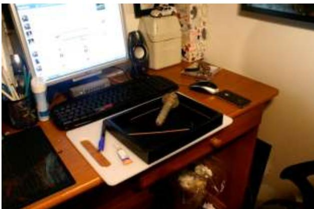
Depois de colocada a cola (qb) na estrutura da madeira, convém colocar algo pesado em cima, para que esta, faça o efeito devido e que se una fortemente. Neste exemplo, foi usado um parafuso de via-férrea que tinha à mão e foi por momentos, bastante útil, pois pesa consideravelmente e para a ocasião foi suficiente. Aguarda-se 10 a 15 minutos, e vesse se a cola que usamos está suficiente seca e se a base está
